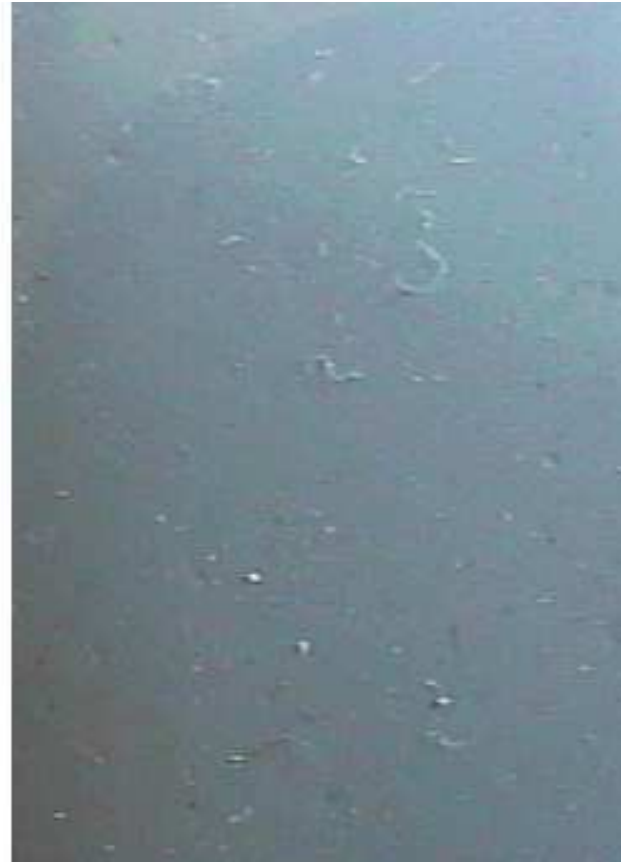
Gel Coat com Cab-O-sil M5 + 30% de aditivo
