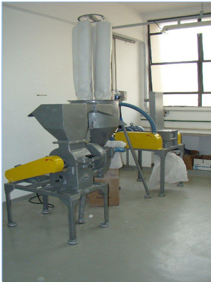
Conjunto triturador e moinho Instalados CETECOM
