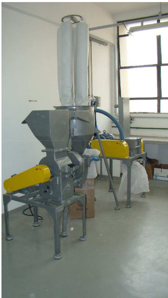
Conjunto triturador e moinho Instalados CETECOM
